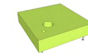
3 Base carrée pour le tube à bulle et la fibres optiques
